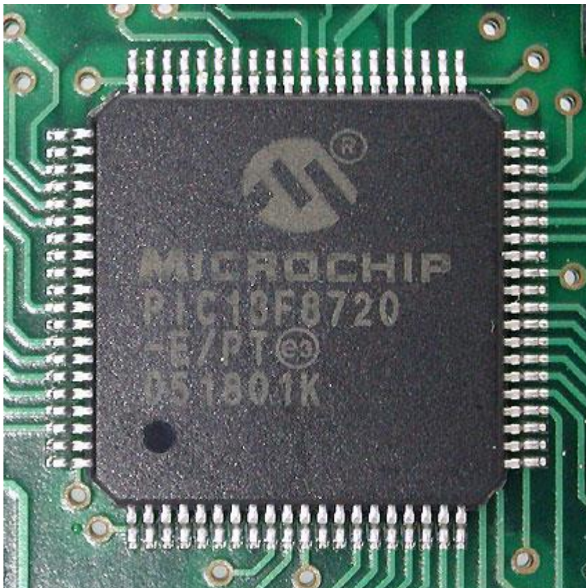
PIC 18F8720 microcontroller 80 lábú tokozásban (12 x 12 x 1mm)
